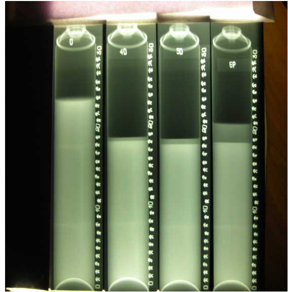
Rys.19 Obraz radiograficzny przedstawiający wypełnienie pojemników pianką
