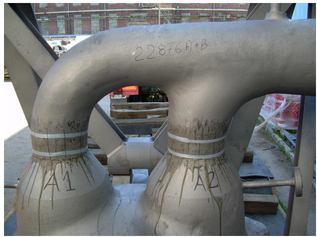
Rys. 6 Połączenie spawane elementów odlewanych przewidziane do badania radiograficznego
