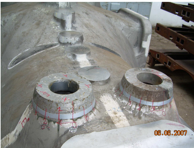
Rys. 5 Króćce odlewu stalowego przewidziane do badania radiograficznego w obszarze L = 100 \text{ mm} przed wykonaniem połączenia spawanego
